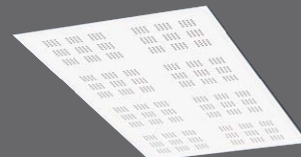
BIG Quattro 47 Hullstørrelse: 12 x 12 mm, c/cs 25 mm Hullareal: 6 % Modulformat: 1200 x 2400 mm* Tykkelse: 12.5 mm
