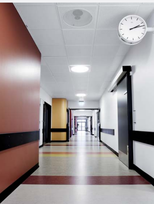
Korridor på Onkologisentret i Herning. Himling: Gyptone Point 11 – kant E
